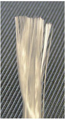
Le fibre di vetro sono utilizzate per la produzione di materiali compositi ovvero materiali strutturali avanzati in cui diversi componenti sono integrati tra loro per produrre un materiale di caratteristiche superiori da un punto di vista fisico, meccanico, chimico, estetico, ecc.
